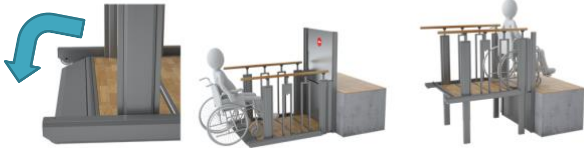
Şekil 4: rampa kat seviyesine iner
